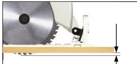
Adjust the cutting depth to the thickness of the workpiece. Less than a full tooth of the blade teeth should be visible below the workpiece. Passen Sie die Schnitttiefe an die Dicke des Werkstücks an. Es sollte weniger als eine volle Zahnhöhe unter dem Werkstück sichtbar sein. Adapter la profondeur de coupe à l'épaisseur de la pièce. Moins d'une dent complète devrait apparaître sous la pièce.
